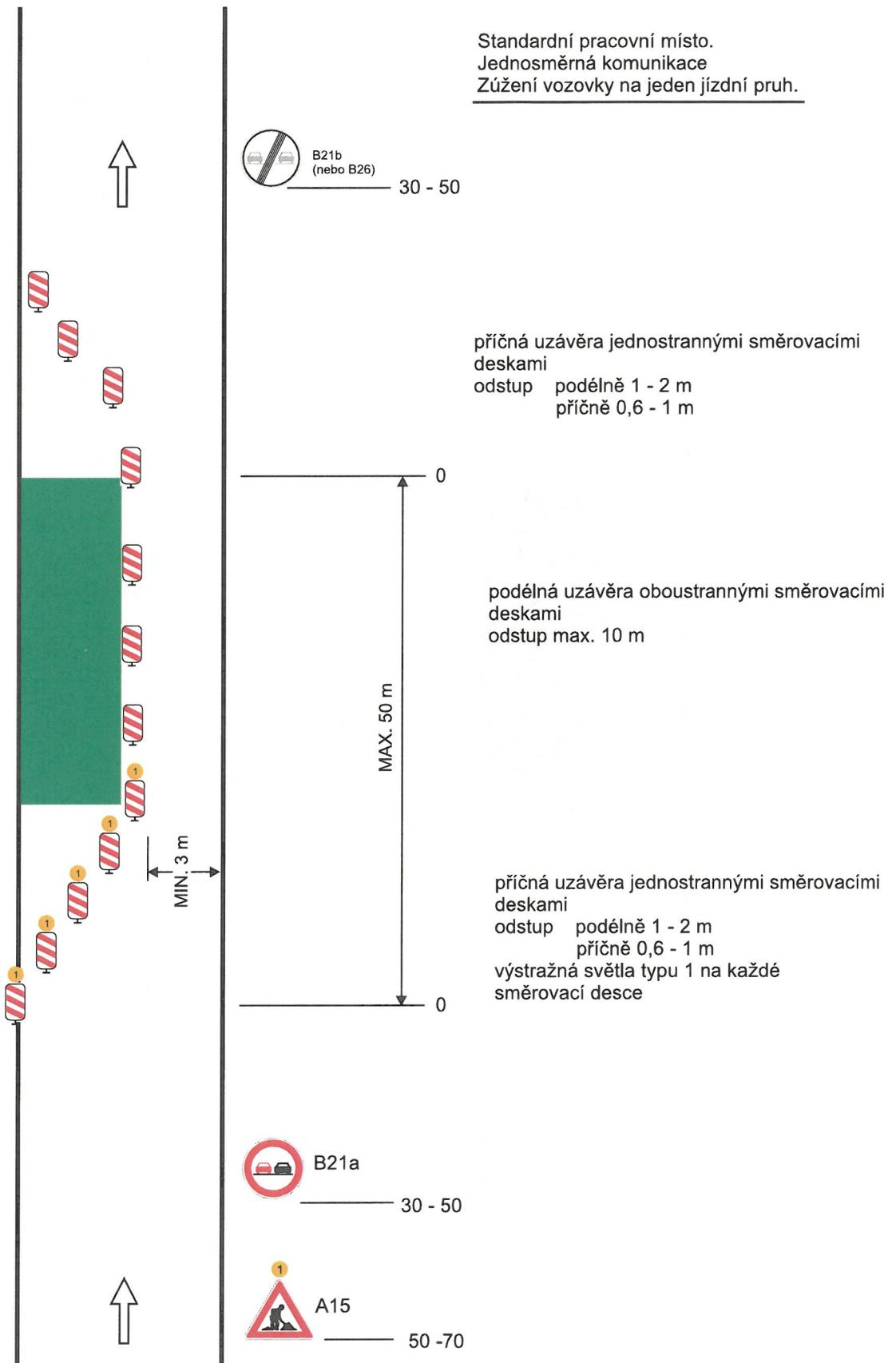
Schéma pro označení pracovního místa na komunikaci s max. dovolenou rychlosí do 50 km/h - modifikace schemata B/5.1
