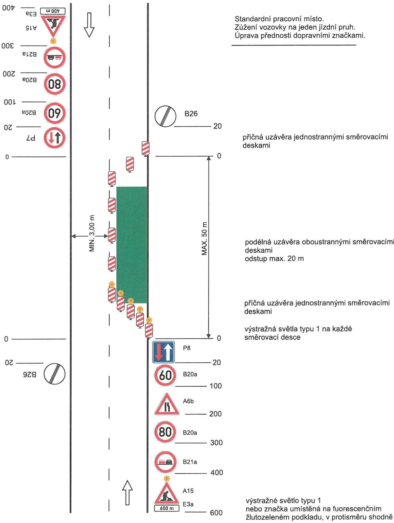
Schéma pro označení pracovních míst na komunikaci s max. dovolenou rychlosí do 90 km/h - modifikace schémata C/12
